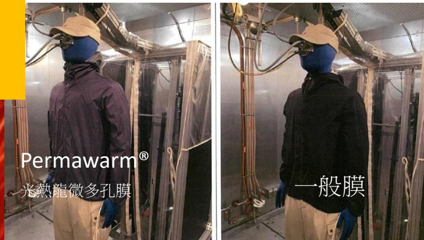
福懋興業發展第三代防水透濕+蓄熱保溫布料科技,目前推廣予各大戶外運動品牌運用於秋冬季衣著,此種最新的複合配方防水透濕+蓄熱保溫布料,比傳統的發熱布料有更快及更高效率的蓄熱升溫表現,以遠紅外線蓄熱保溫測試,溫度可提升10°C以上,是目前市售防水透濕+蓄熱保溫,機能性效果最佳的布料。
